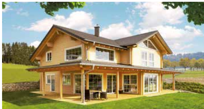
1,5-stöckiges Einfamilienhaus mit 24 cm starken Blockbohlenwänden ohne zusätzlicher Dämmebene – ökologisch und nachhaltig.
