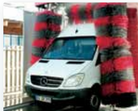
Portal-Anlage für Transporter
